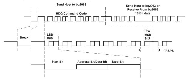
Figure 10. HDQ16 Communication Example
