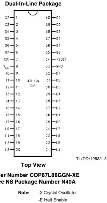
**FIGURE 2. Connection Diagrams**
