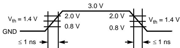
(d) CML/LVPECL Input Test Waveform
