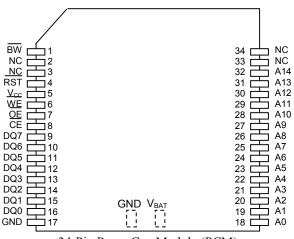
34-Pin PowerCap Module (PCM) (Uses DS9034PC PowerCap)
