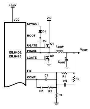
FIGURE 3. OUTPUT VOLTAGE SELECTION
