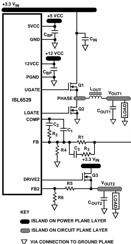
FIGURE 7. PRINTED CIRCUIT BOARD POWER PLANES AND ISLANDS
