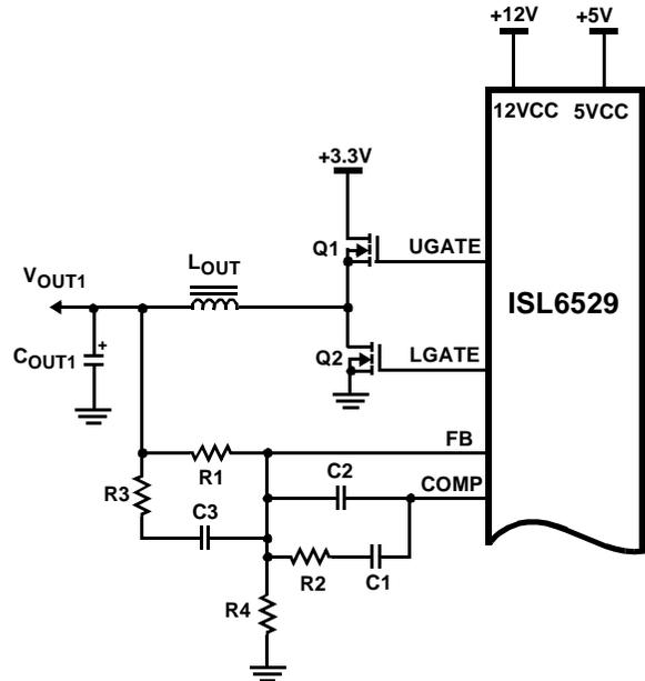
FIGURE 3. OUTPUT VOLTAGE SELECTION OF THE PWM
