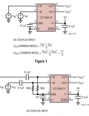
$V_{IN}$  (COMMON MODE) =  $V_{OUT}$  (COMMON MODE) =  $\frac{V^+}{2}$
