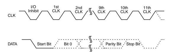
Figure 12-6. PS/2 Transmit Data Byte Timing
