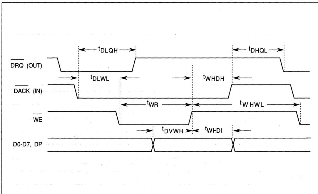
FIGURE 9-7. DMA WRITE
